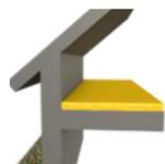
**Ajout d'une isolation sur le plancher des combles perdus : 400 mm de ouate de cellulose soufflée R = 10.0 m<sup>2</sup>.K/W**
